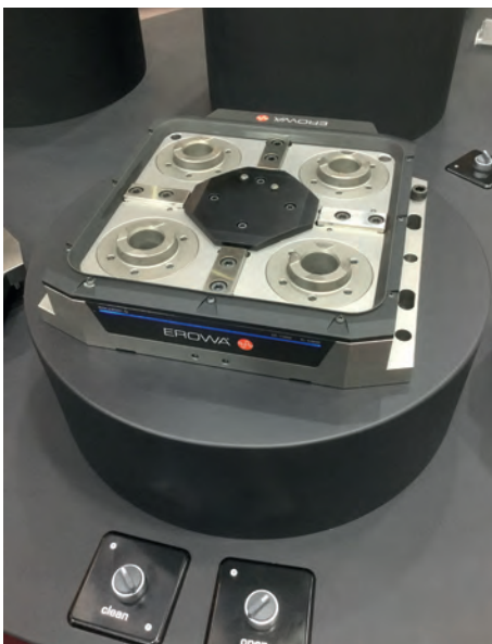
› Les mandrins « Edge20 » transmettent en temps réel leur état et la pression de serrage via l'application SmartChucks
