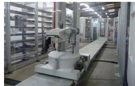
>> Des magasins en suffisance le long des rails du robot ERD Erowa.
